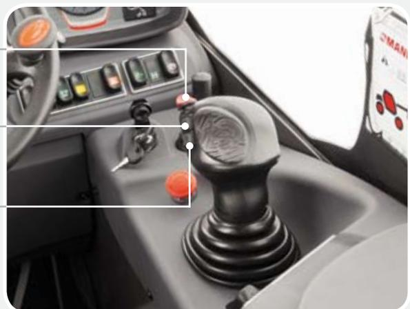
Mit dem JSM werden alle Teleskopfunktionen proportional und unabhängig voneinander angesteuert, so dass die Vorgänge beschleunigt werden.
