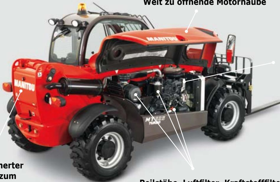
Wartungsarbeiten werden durch die optimale Erreichbarkeit der Aggregate und durch die Anzeige der Wartungsintervalle und der Diagnosecodes am Armaturenbrett erheblich erleichtert.
