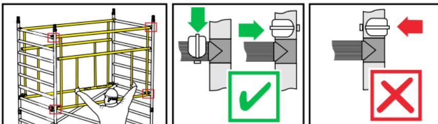
Längsriegel und Geländer auf ordnungsgemäße Montage prüfen. Montage stets wie in Abbildung.
